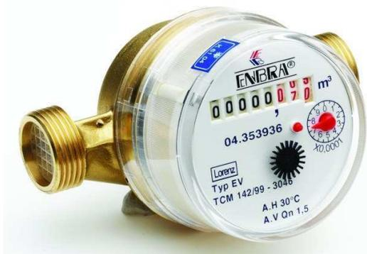
Bytové vodoměry slouží k měření odběru studené a teplé vody v bytech, ale i nebytových prostorách, kde je předpokládán odběr vody srovnatelný se standardní spotřebou bytové jednotky. Pro uvedené podmínky se instalují jednovtokové lopatkové suchoběžné vodoměry s magnetickou spojkou v provedení EXTRA s povrchovým pokovením niklem nebo chromem, nebo v levnější verzi ULTRA s nepokoveným povrchem.
